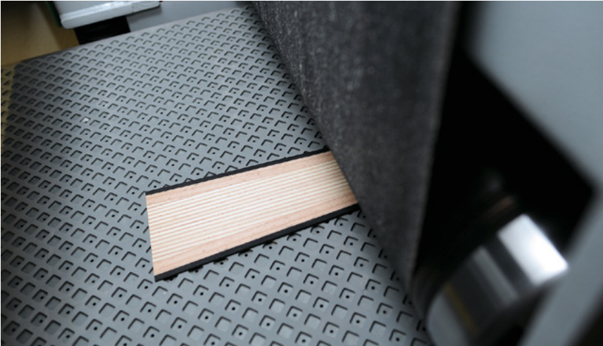
Das Transportband saugt die Teile mit Unterdruck an. Erst durch die sichere Aufspannung sind die hohen Zerspanungsleistungen der Schleifmaschine möglich.
