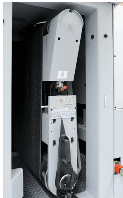
Das gesamte Schleifaggregat ist in Echtzeit in der Z-Achse beweglich.
